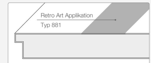
In verschiedenen Oberflächen und Abmessungen werden die Applikationen bündig in das Türblatt eingelassen.
