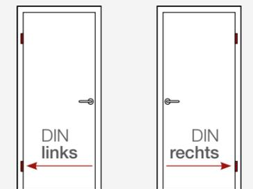
Die DIN Richtung gibt an, in welche Richtung die Tür geöffnet wird. Sie wird von der Türseite aus ermittelt, an welcher sich die Bänder befinden.
