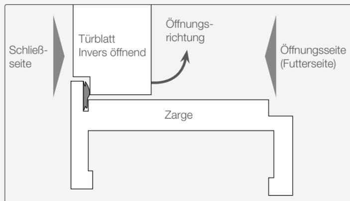
Im geschlossenen Zustand ist die Schließseite bündig. Die inverse Tür hat eine entgegengesetzte Öffnung - zur Futterseite des Elements.
